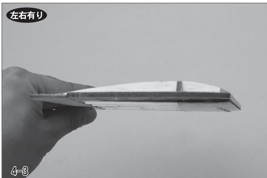
翼端は主翼下面に対して前縁側で持ち上がるようになります。
