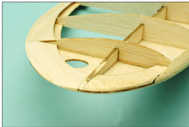
翼端前縁部分の成型は写真のようになります。削り過ぎないようにしましょう。
