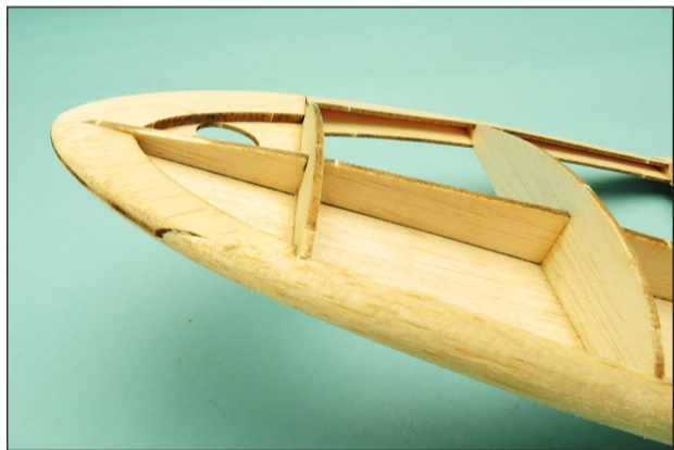
翼端前縁部分の成型は写真のようになります。削り過ぎないようにしましょう。
