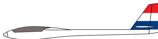
名機QBシリーズの復活です。バルサ不足が続いていますが、打開策として30年ぶりにベニヤを主材料としたレーザーカット木製キットとして復活します。ただ単にリメイクではなく完全新設計。最新の翼型を採用しカーボンカンザシによる2分割主翼で、リンケージ内蔵のフルフライングテール水平尾翼を採用しました。もちろん電動サーマルグライダーです。
