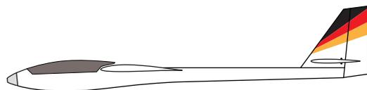
名機QBシリーズの復活です。バルサ不足が続いていますが、打開策として30年ぶりにベニヤを主材料としたレーザーカット木製キットとして復活します。ただ単にリメイクではなく完全新設計。最新の翼型を採用し、フラップ付きとして組み立てることも可能です。リンケージ内蔵のフルフライングテール水平尾翼を採用しました。もちろん電動仕様にもなるスロープスタントグライダーです。
