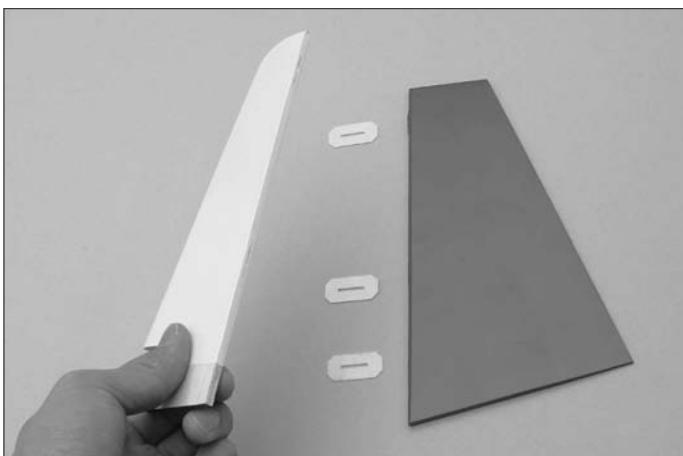
(4) 垂直尾翼からラダーを取り外します。ヒンジは差し込んであるだけですでの、引っ張るだけで取り外すことができます。
