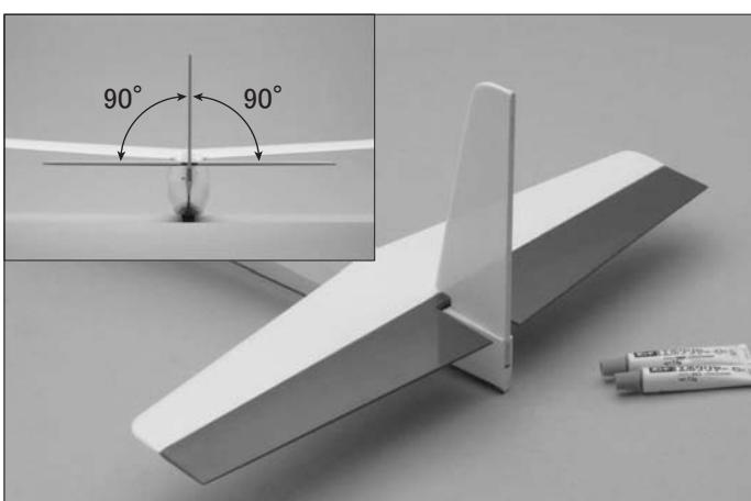
(5) 垂直尾翼を胴体に30分硬化型のエポキシ接着剤で接着します。垂直尾翼は水平尾翼と直角にならなければなりません。
