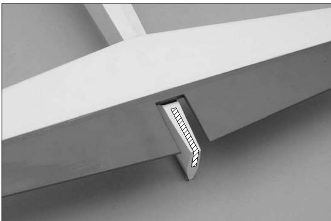
(3) 脇体の垂直尾翼取付部分(図の斜線部分)のフィルムを切り取ります。
