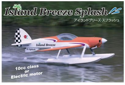
「アイランドブリーズ・オレンジ」に水上機バージョンが登場。専用に開発 された新設計のフロートにより、素晴らしい離水性能と着水性能を発揮 します。防水性を考えた主翼の上面リンケージやアウターパイプを使っ たカーボンリンケージ、フロート装着による前面空気抵抗の増加に対応 するためのフィンの追加などOK模型ならではの長年の水上機開発の ノウハウを惜しみなく投入しました。
